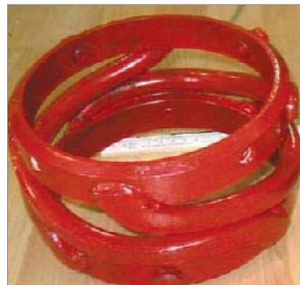
**Рис. 4.** Деформированный в проблемных участках ствола сварной центратор ЦТП-С 168/216
