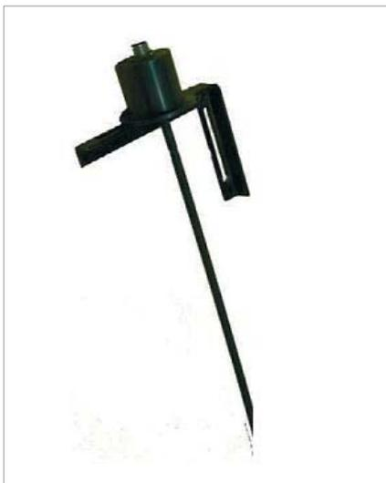
**Рис. 4.** Индикатор потока на выходе
