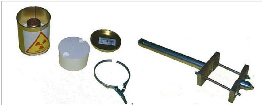
**Рис. 2.** Датчик плотности БР на входе с использованием радиоактивного источника малой интенсивности Na22
