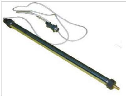
Рис. 6. Датчик температуры бурового раствора
