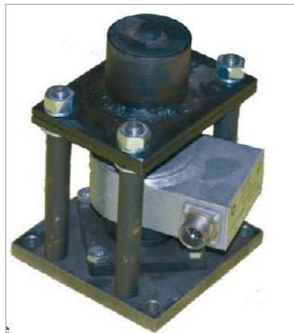
Рис. 8. Датчик момента на роторе
