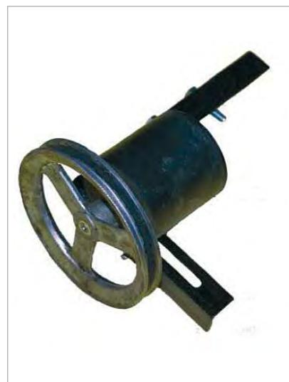
**Рис. 5.** Датчик положения лебедки
