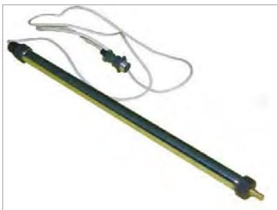
Рис. 6. Датчик температуры бурового раствора
